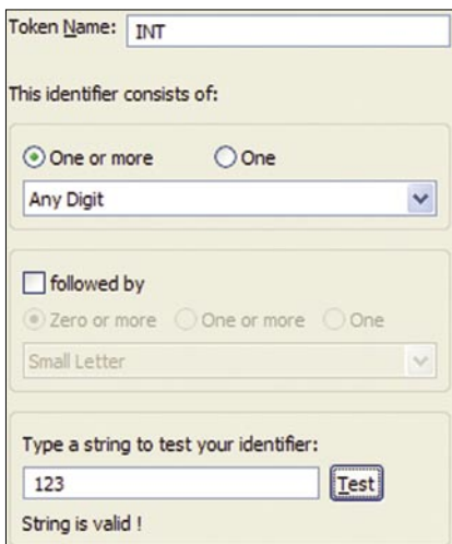
Abbildung 6. Man muss nicht länger manuell komplexe Regeln zur Definition von Identifikatoren schreiben. Der Lexer-Assistent erlaubt sogar, den Identifikator auf der Stelle zu testen!
